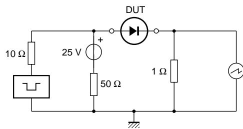
Input impedance oscilloscope:  $1 \text{ M}\Omega$ ,  $22 \text{ pF}$ ;  $t_r \leq 7 \text{ ns}$ .
